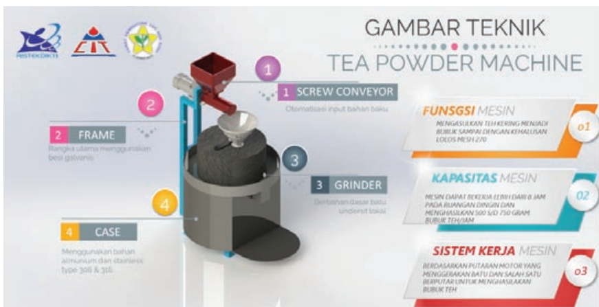
Gambar 1. Gambar teknik teknologi mesin penghasil bubuk teh hijau yang dikembangkan oleh Pusat Penelitian Teh dan Kina bekerja sama dengan CV. Cihanjuang Inti Teknik
