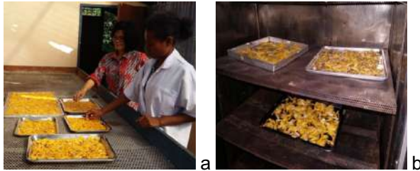
Gambar 8. Pengerinan irisan daging buah pandan tikar; pengerinan menggunakan rumah pengering (a); dan menggunakan oven pengering (b).
