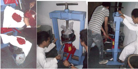
Gambar 8. Proses pengempaan minyak buah merah menggunakan alat kempa hidrolik (*hydraulic press*)
