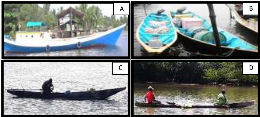
Gambar 8. Alat Transportasi yang Digunakan dalam Kegiatan Perikanan Tangkap di Sorong Selatan. A. Perahu Jolor (Menggunakan Motor Dalam), B. Perahu Motor Tempel, C. Perahu Katinting, D. Perahu Dayung.
