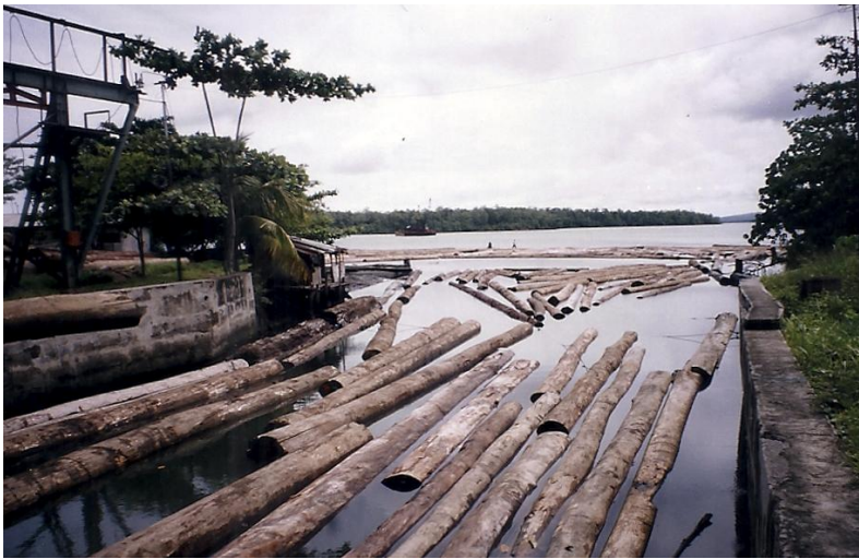
Gambar 2.2 Tempat penyimpanan kayu di air laut (log pond)
