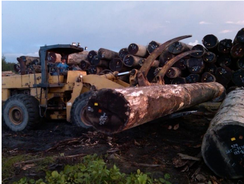
Gambar 8.1. Traktor kepiting ( jack loader ) untuk memindahkan kayu log
