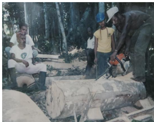
Gambar 7.9 Breakdown saw dengan menggunakan chain saw
