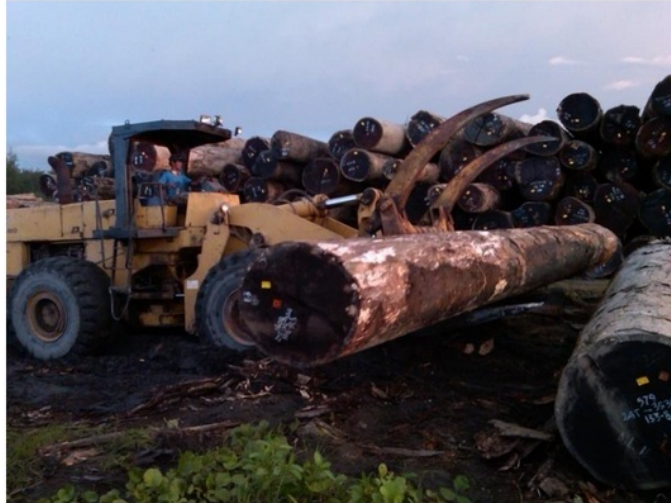
Gambar 8.1. Traktor kepingting ( jack loader ) untuk memindahkan kayu log
