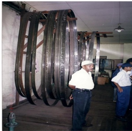
Gambar 11.5 Penyimpanan bandsaw secara vertikal pada salah satu saw doctor home industri penggergajian kayu terpadu di tanah Papua
