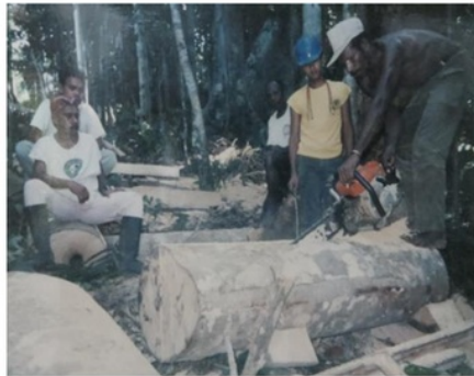
Gambar 7.9 Breakdown saw dengan menggunakan chain saw
