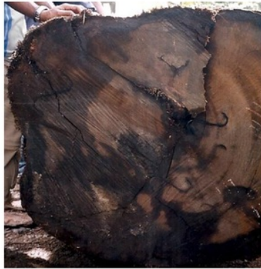
Gambar 12.1. Pemasangan paku S untuk mencegah pecah pada kayu log
