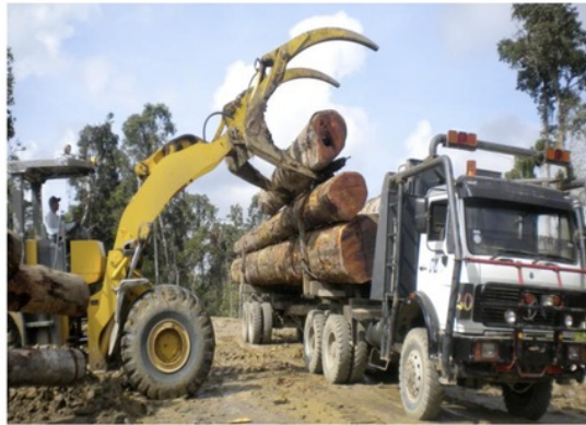
Gambar 8.3. Truk loging yang dipakai untuk mengangkut kayu-kayu dari hutan alam tropis
