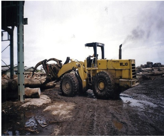
Gambar 8.4 Jack loader sedang memindahkan kayu log di TPN
