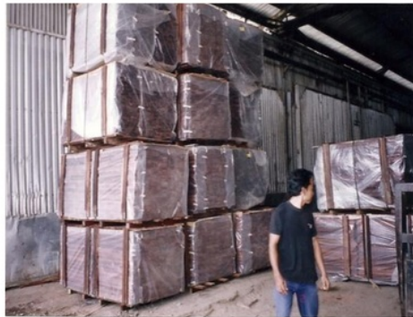
Gambar 12.2. Pengemasan kayu gergajian papan pendek dari jenis Merbau ( Instia spp )
