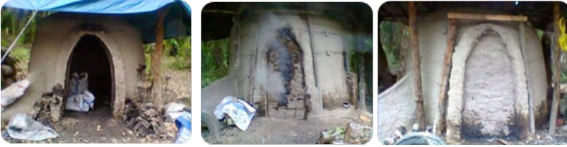
a) persiapan dan penyusunan kayu b) pembuatan arang c). Pendinginan kilang
