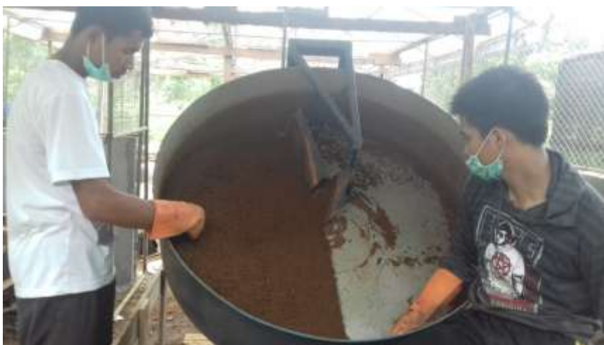
Gambar 6.2. Alat Granulator untuk pembuatan pupuk fosfat granul
