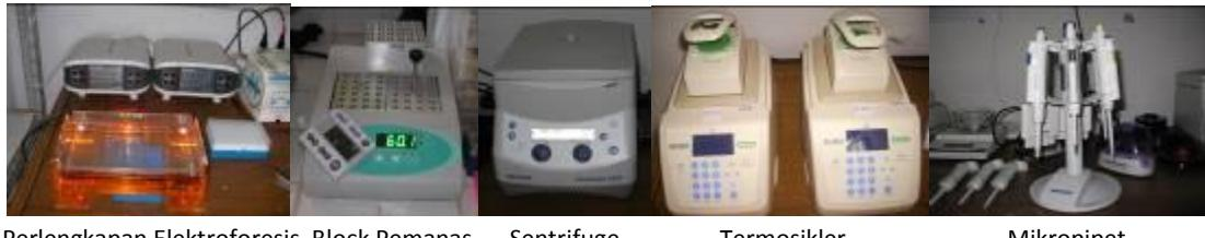
Perlengkapan Elektroforesis Block Pemanas Sentrifuge Termosikler Mikropipet
