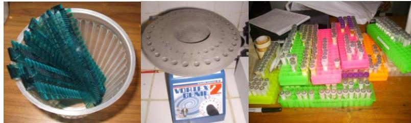
Sisir gel elektroforesis Vorteks Tabung dan Rak Tabung
